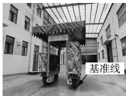
图 15 直线行驶偏移率试验 Fig. 15 Straight-line offset test
